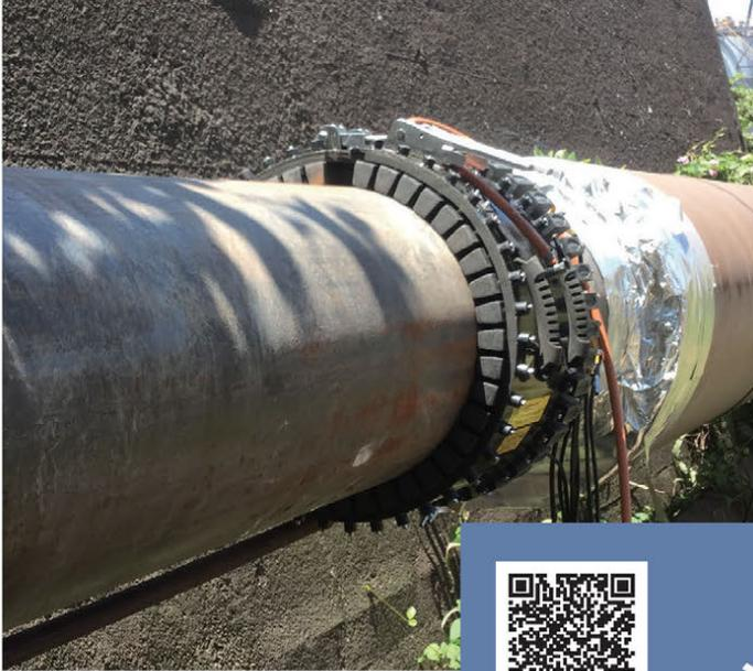
長距離超音波（ロングレンジガイド波）を用いて広域の配管を検査
