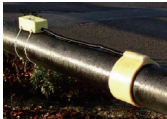
図 17 恒久設置タイプセンサ
