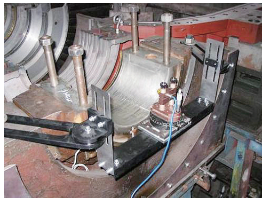
写真4 レーザー取付状況
