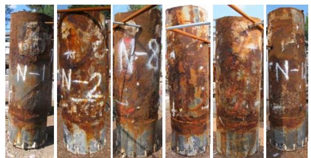
写真-2 実腐食計測試験体
