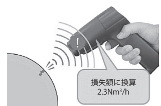
図-10 ソニックマン検出原理
