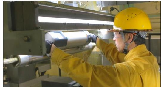
写真3 パラライン計測器による実際の測定風景
